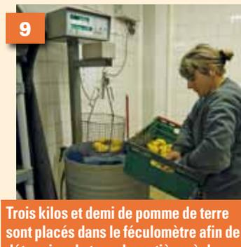
9 Trois kilos et demi de pomme de terre sont placés dans le féculomètre afin de déterminer le taux de matière sèche.
